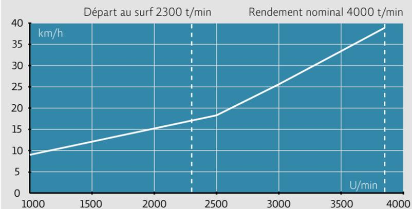
Point mort: 700 t/min, vitesse max.: 38,9 km/h à 3850 t/min. Mesuré sur le lac de Morat, avec le GPS, 3 personnes à bord, pas de vent, pas de vague.
