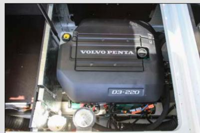
Le bateau testé était équipé d'un Volvo Penta D3-220, qui remplit la norme RNC. Les 220 cv suffisent amplement pour propulser le bateau à une bonne allure, tout en permettant d'avoir toujours suffisamment de puissance en réserve. Sachant que nombre de clients Nimbus privilégient la conduite confortable, le 305 Coupé est également proposé avec le D3-110 et le D3-150. Cela étant, motorisation plus faible est tout à fait envisageable suivant la zone de navigation.
