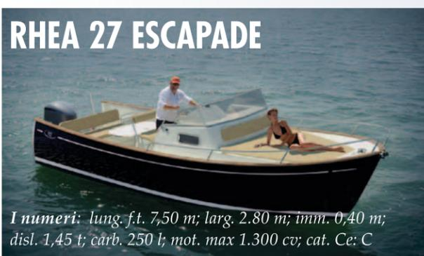
I numeri: lung. f.t. 7,50 m; larg. 2,80 m; imm. 0,40 m; disl. 1,45 t; carb. 250 l; mot. max 1.300 cv; cat. C: C
