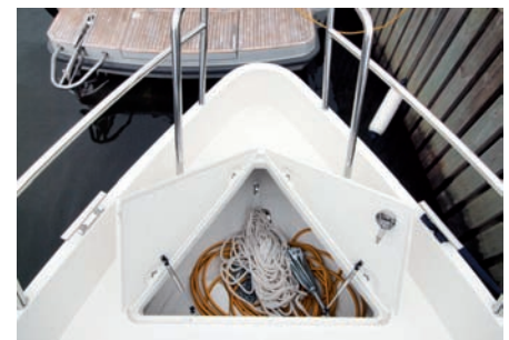
Stauraum satt und Liebe zum Detail: Gasdruckaufsteller an den Lukendeckeln.
